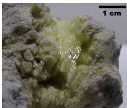
図2 . 火山ガスから昇華した単斜硫黄の針状結晶。写真中央部が淡黄色。
